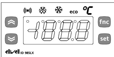
Al encenderse el instrumento realiza un Lamp Test (Chequeo Pilotos); durante unos segundos el display y los leds parpadean, comprobando la integridad y el buen funcionamiento de los mismos. El instrumento dispone de dos Menús principales, el Menú “Estado de la máquina” y el Menú de “Programación”.
