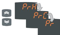
Pulse la tecla 'set' cuando se visualiza la etiqueta **Pid** para ver la etiqueta de la primera subcarpeta **PrH**. Use las teclas UP y DOWN para recorrer las subcarpetas.
