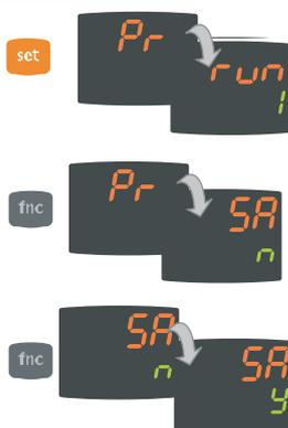
Pulse la tecla 'set' cuando se visualiza la subcarpeta deseada para acceder a los parámetros. Para recorrer los parámetros pulse la tecla 'set'; para modificar un valor pulse las teclas UP y DOWN.
