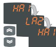
Si hay alarmas, pulse las teclas UP y DOWN para verlas y seleccionarlas.
